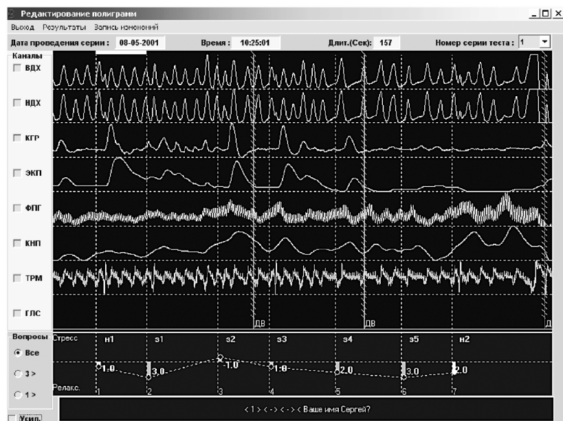
Рис. 3.20. Экран полиграфа с графическим изображением физиологических параметров, отражающих состояние человека
