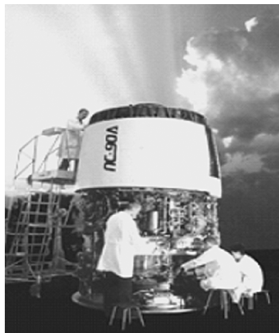
Рис. 3.19. После выполнения определенного количества полетов двигатель снимается с самолета и подвергается стендовой разборке
